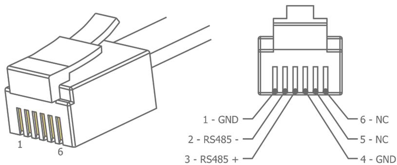
Figure 11. RJ12 pins
